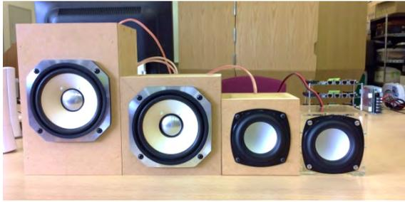
Fig. 2 作成したスピーカ (左から、音響樽と同等のエンクロージャ、12cm ユニット小型エンクロージャ、8cm 木製エンクロージャ、8cm アクリルエンクロージャ)
