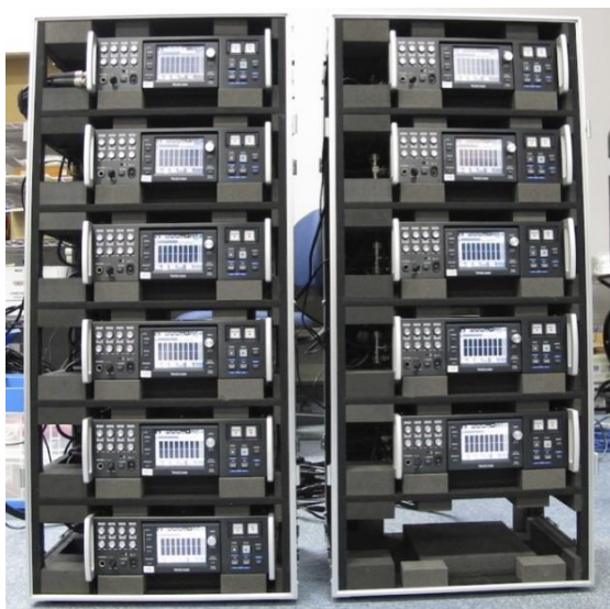
図7 8ch フィールドレコーダを用いた収録システム
