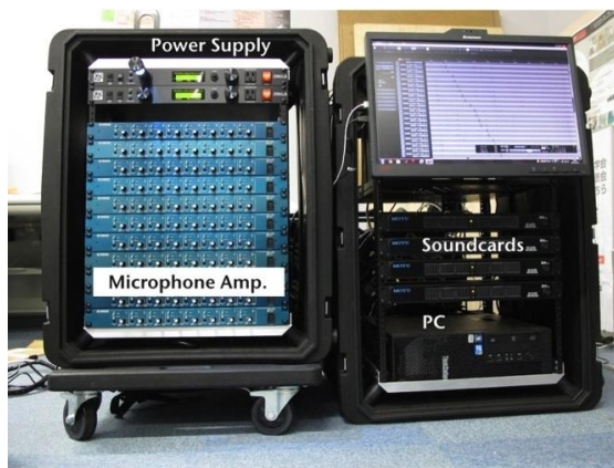
図6 PCを用いた収録システム
