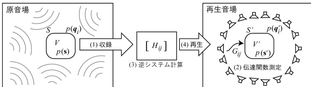
図1 BoSC 原理による音場再現
